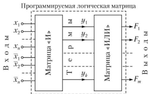
Рис. 21.20. Блок-схема ПЛМ с n входами, m выходами и k термами
