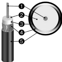
Рис. 2.2. Коаксиальный кабель: 1 – центральный проводник CCS; 2 – диэлектрическая прослойка из полиуретана; 3 – экран из алюминиевой фольги; 4 – экран из алюминиевой проволоки; 5 – оболочка из УФ-стабилизированного ПВХ
