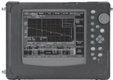
Рис. 6.2. Рефлектометр
