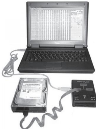
Рис. 6.5. Анализатор протоколов
