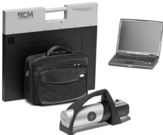
Рис. 2.71. Рентгенотелевизионный комплекс Flat Scan 27
