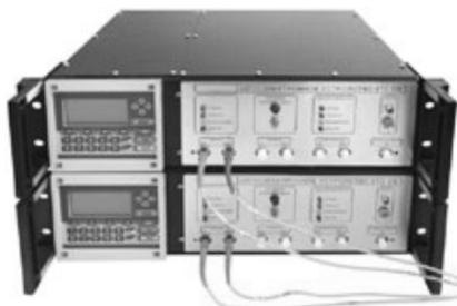
Рис. 1.39. Комплекс технических средств контроля НСД к оптическим волокнам
