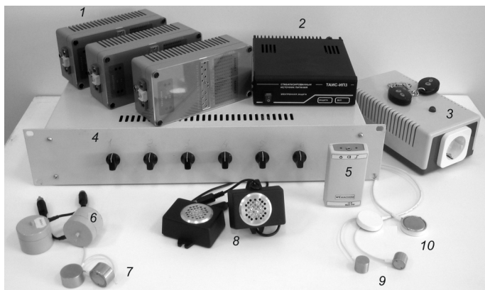
Рис. 4.8. Общий вид основных составляющих частей системы «Шорох-3»: 1 — блоки ГШВА-2; 2 — блок питания ТАИС-ИПЗ; 3 — «Шорох-ДУ»; 4 — блок УС-6; 5 — устройство ГУ; 6 — преобразователи КВП-2; 7 — преобразователи ПЭД-5; 8 — преобразователи АСМик-1; 9 — преобразователи ПЭД-5; 10 — преобразователи КВП-7
