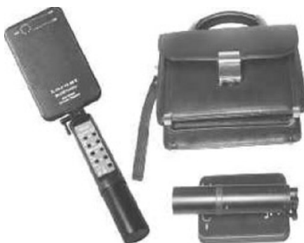
Рис. 2.61. Досмотрово-поисковый локатор «Лорнет-24»
