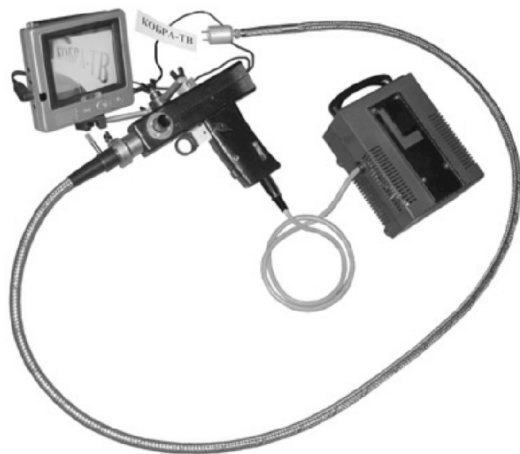
Рис. 2.81. Телевизионный эндоскоп «Кобра-ТВ»
