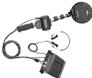
Рис. 2.57. Нелинейный радиолокатор NR-900EMS
