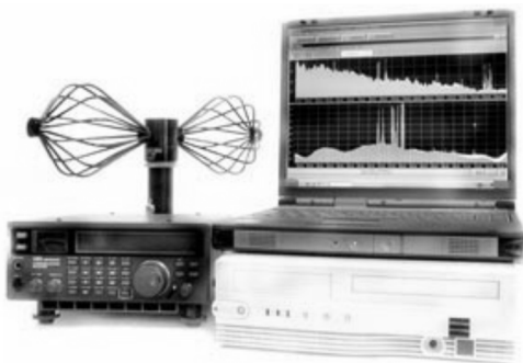
Рис. 5.61. Комплекс для исследований ПЭМИН «Зарница-П»
