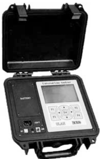
Рис. 5.12. Универсальный анализатор линейных коммуникаций «Улан»
