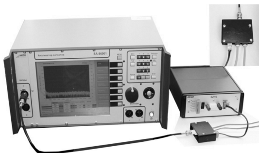
Рис. 5.26. Схема подключения комплекса при исследовании телефонной линии
