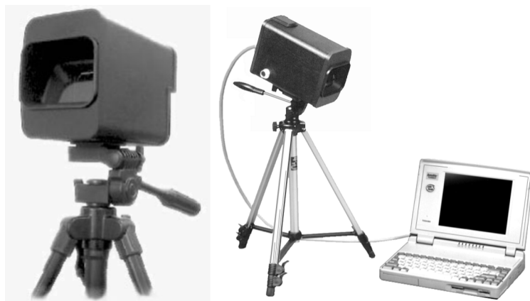
Рис. 2.75. Тепловизионный комплекс IRTIS-2000
