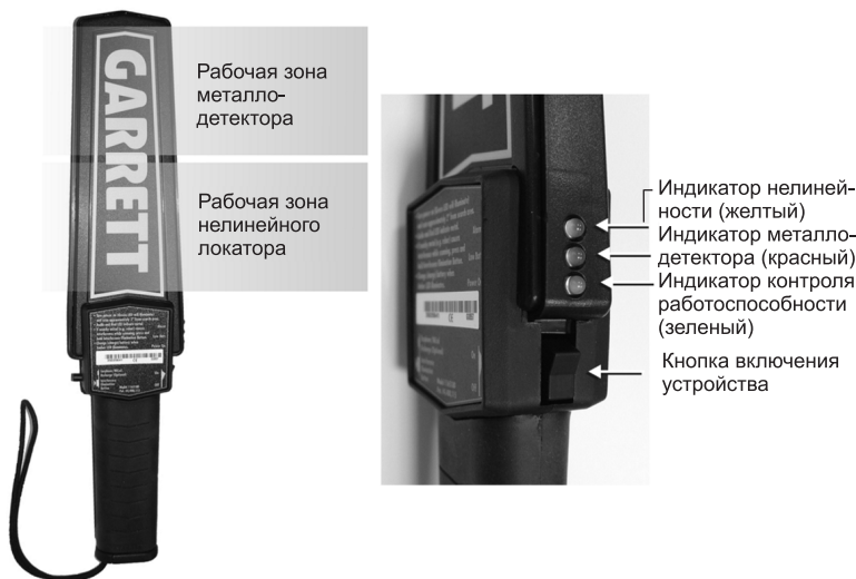
Рис. 2.63. Комбинированное устройство «Буклет-МД»
