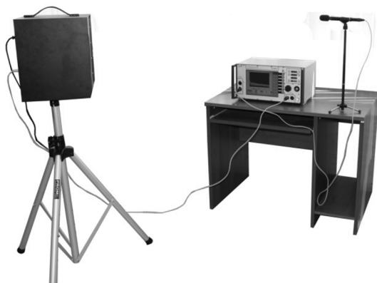
Рис. 5.25. Схема подключения комплекса при выявлении микрофонного эффекта
