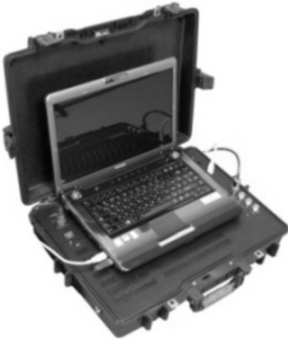
Рис. 2.45. Комплекс радиомониторинга «Касандра»
