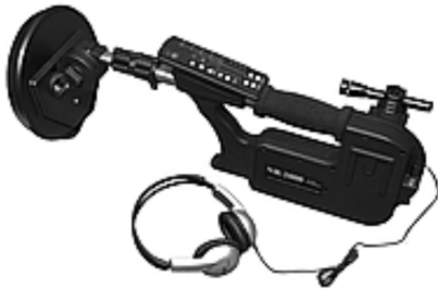
Рис. 2.58. Нелинейный радиолокатор NR-2000
